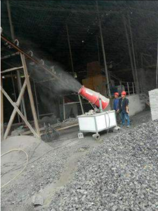
皮带运输及落料区喷雾除尘
